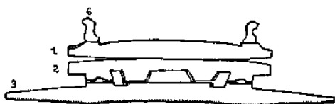
6—6/a. ábra. Az előszekér részei: 1. fergettyű; 2. párna; 3. tengely (ostor), 4. éha; 5. orra; 6. koslantyú.
